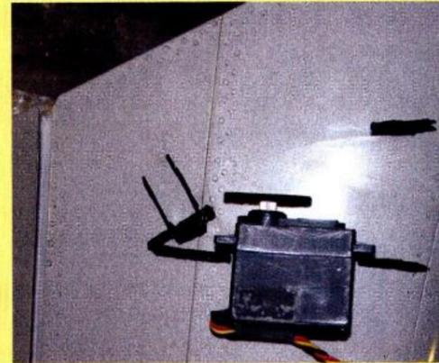
Hier wird der Einbau des Höhenruderservos verdeutlicht – die Edding-Linien zeigen die Position der Rippen und Steckung
