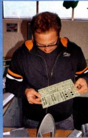
Der komplette Satz GFK-Anlenkteile vereinfacht den Bau erheblich
