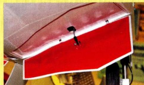
Die Landeklappen unter dem Rumpf: die Anlenkung erfolgt aus dem Rumpf heraus. Hier sieht man auch die besagte Rumpfform, die den richtigen Scharnierpunkt erfordert.
