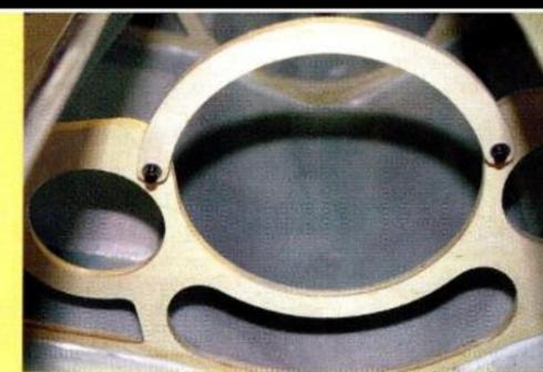
Der kurze Bogen schließt den Spant zu einem Ring und hält die GFK-Röhre
