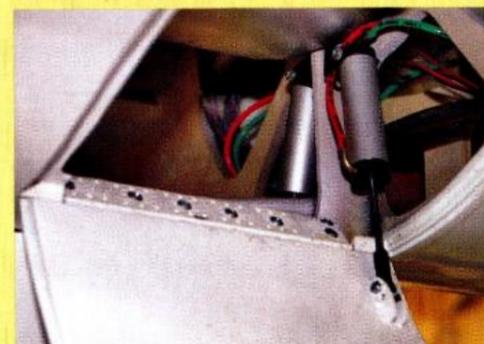
Die Klappen des Hauptfahrwerks sind mit Kavan-Scharnieren angeschlagen. Der Einbauplatz für die Zylinder ist sehr begrenzt, aber es funktioniert.
