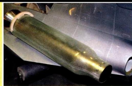
Hier ist zu sehen, wie das Schubrohr in der GFK-Röhre sitzt. Vorne musste die Röhre um etwa 5 cm gekürzt werden.
