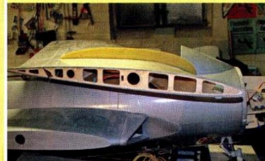
Durch die Aussparungen der Wurzelrippe ist der Flügel gut zugänglich, um die Verklebung der tragenden Teile zu kontrollieren. Der Grenzschichtzaun ist aus GFK gefertigt.
