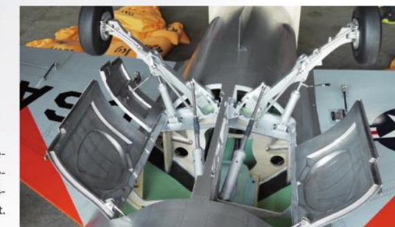
Das Fahrwerkskinematik hat sich bereits bei der 1:4-Version bewährt.
