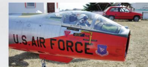
Der Rumpf der XXXL-Version ist in vier Segmente geteilt – die Nase lässt sich mittels Bajonett-Verschluss für Servicezwecke mit einem Handgriff abnehmen.
