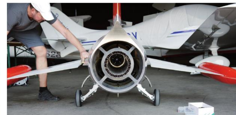
Beim Blick ins Heck offenbart sich der Raum im Inneren – selbst ein 550-N-Triebwerk verliert sich in der Tiefe und das Schubrohr benötigt lediglich den halben Auslassdurchmesser.
