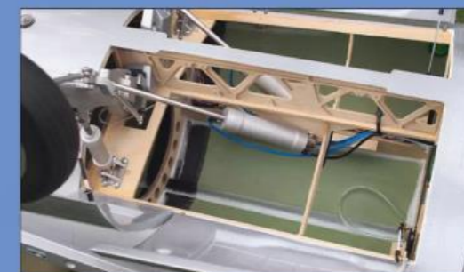
Das Hauptfahrwerk wird von zwei kräftigen Druckluftzylindern bewegt und in den Endpositionen gehalten
