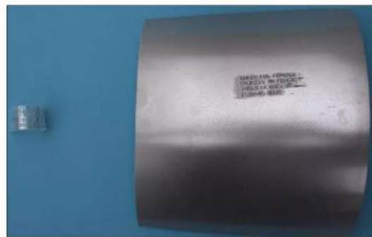
Problemfall: Der Lack löst sich mit der Trägerfolie wieder ab – zum Glück hier am Probestück
