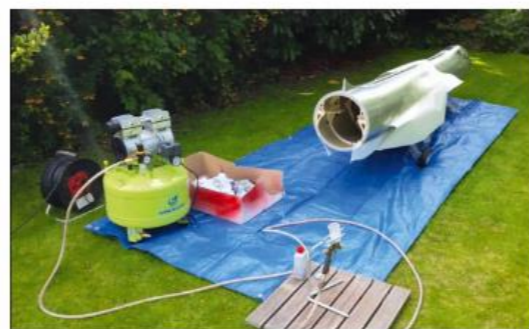
Der schnelltrocknende Lack kann durchaus auch im Garten aufgespritzt werden. Die Metalloberfläche wird durch abschnittsweise Lackierung mit Speziallack imitiert
