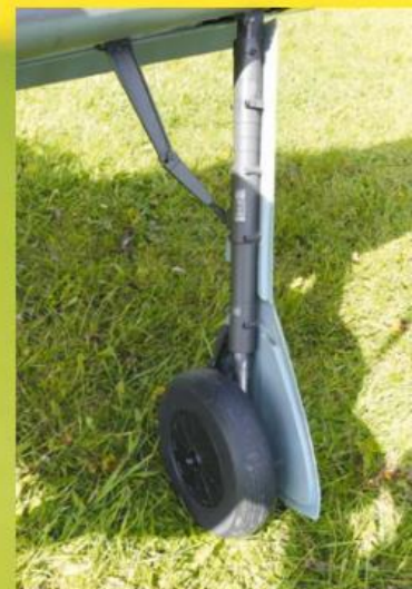
Das relativ lange und sehr schön detaillierte Fahrwerk ist weit stabiler, als es beim ersten Hinsehen erscheint. Auch die ab Werk vorgerüsteten Fahrwerksaufnahmen in den Flügeln sind entsprechend ausgeführt
