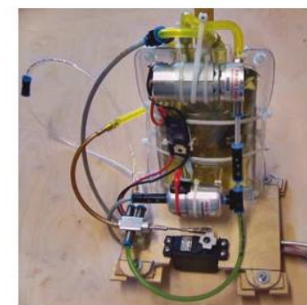
Das Hydraulikaggregat sitzt hinter dem Spant mit der Canardlenkung auf einem Montageträger.
