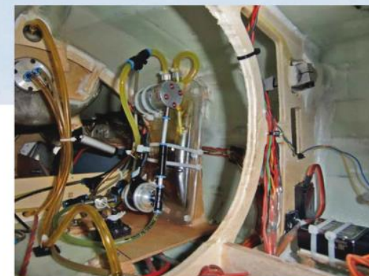
Das Hydraulikaggregat sitzt hinter dem Spant mit der Canardlenkung auf einem Montageträger.
