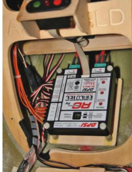
Der Einbau im Modell erfolgte mit schwingungsdämpfenden Kraftstoffschlauch-Distanzstücken.
