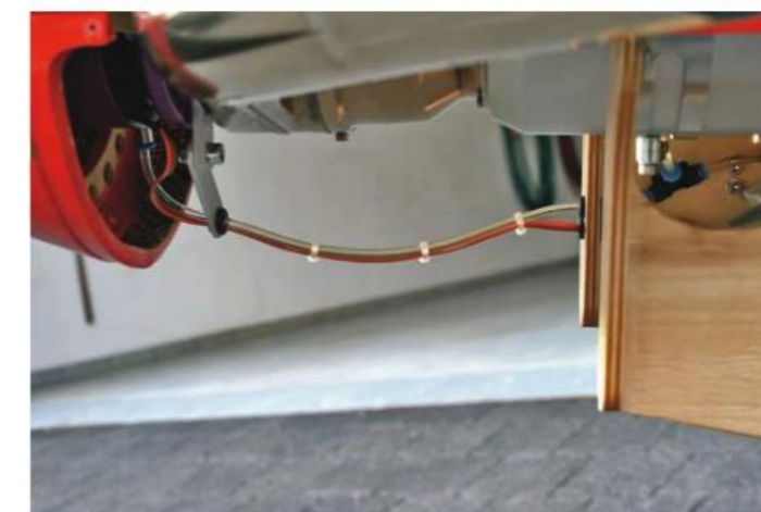
Die Schmierstoff-zuleitung und das Kabel des Drehzahlsensors zum Getriebe muss mit ausreichendem Abstand zu den heißen Teilen der Abgasführung verlegt werden.
