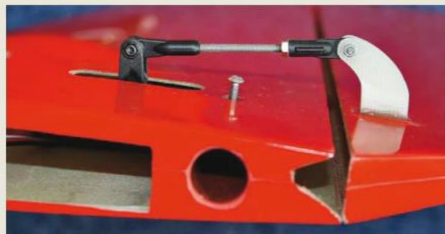
Zu den Gabelhebeln liefert Gabriel die passenden Kugelköpfe – so kann eine perfekte Anlenkung gestaltet werden.
