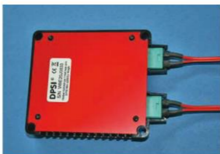
Die Rückseite ist als Kühlkörper gestaltet, bei hoher Belastung sollte der Einbau mit Abstand zum Untergrund erfolgen.
