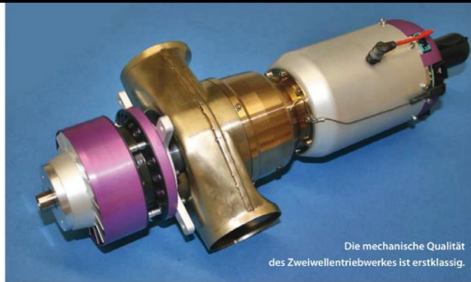
Das Kerntriebwerk hat einen Durchmesser von nur 83 mm und liegt entgegen der Flugrichtung.
