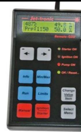
Die GSU zeigt im Grundmenü links Abgas-temperatur und Propellerdrehzahl und rechts Soll- und Istwert der Turbinendrehzahl.
