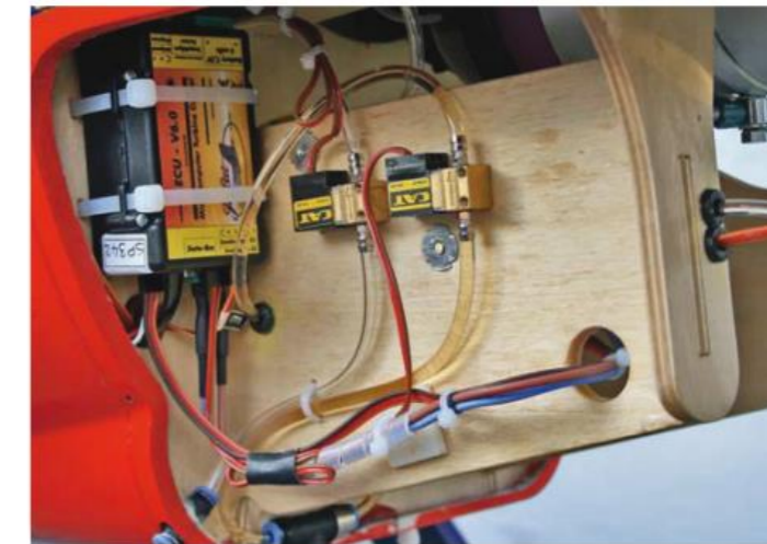
▲ Die Montage der SPT5 ist in der Turbo Raven von Airworld optimal vorbereitet.
