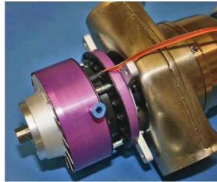
Das bisher von JetCat verwendete Planeten-Untersetzungsgetriebe wird in der neuen Version V3 durch ein Stirnradgetriebe, welches deutlich geräuschärmer läuft, ersetzt.
