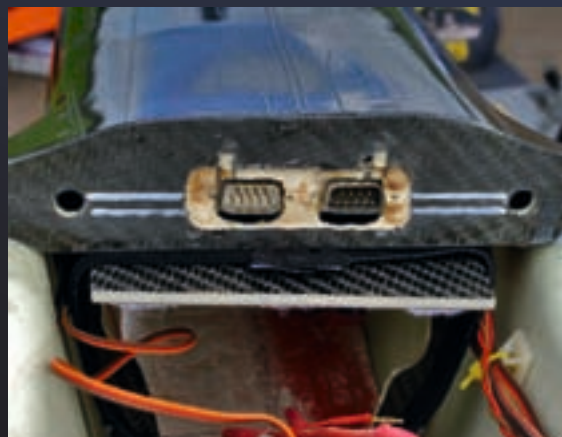
Zwei Sub-D-Stecker sorgen für elektrischen Kontakt der Servos in den Flächen
