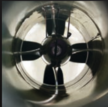
Beim Blick von hinten in den Impeller sind die drei Kupferbleche der Motorzuleitung gut zu erkennen
