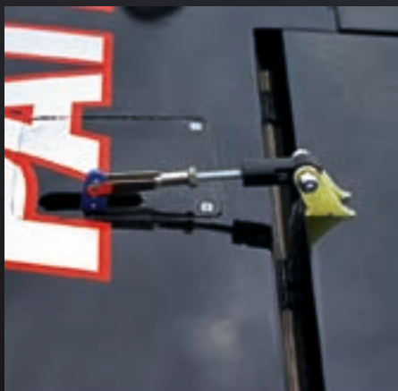
Stabile Anlenkung der Querruder über 3-mm-Kugelkopf und doppelte Ruderhörner
