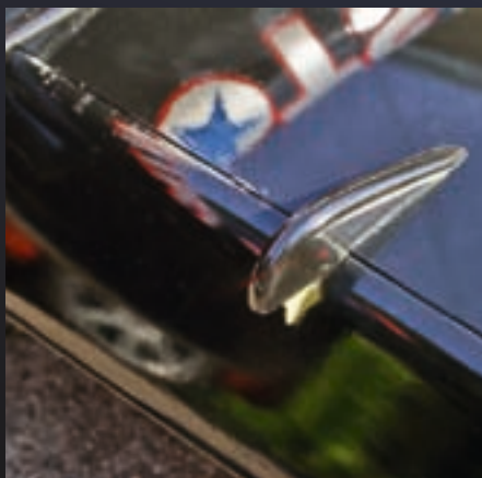
Die Anlenkung der Landeklappen erfolgt auf der Profloberseite – ein selbst gefertigtes Formteil deckt das Ganze aerodynamisch ab
