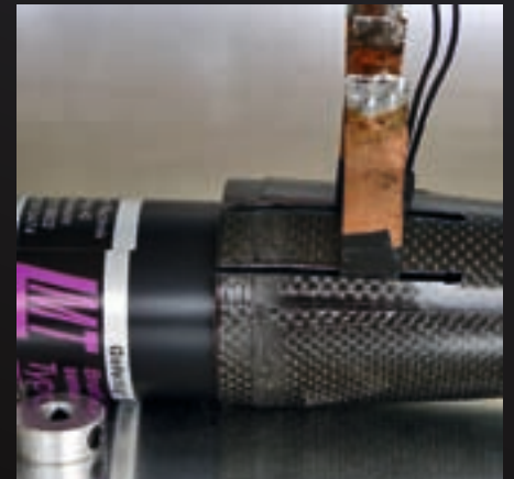
Der Strömungskörper hinter dem Impellermotor besteht aus Kohlefaser und ist leitend, weshalb jede Phase, hier mit schwarzem Isolierband, zu isolieren ist
