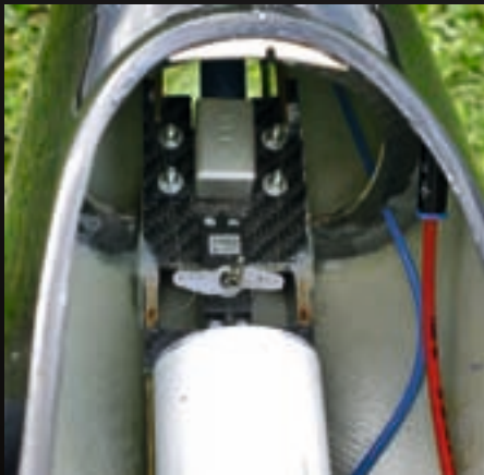
Das Lenkservo und die Bugfahrwerksmechanik sitzen auf kohlefaserverstärkten Pappelsperrholzspanten
