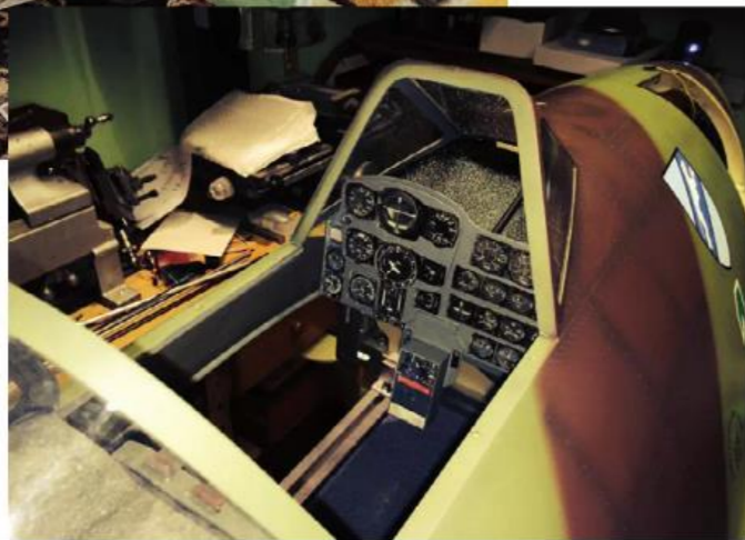
Trotz der selbst auferlegten Vorgabe, überall Gewicht zu sparen, wurde auf einen minimalen Cockpitausbau nicht verzichtet.
