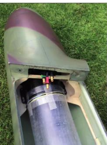
◀ Die 120-mm-Impeller passen perfekt in die Gondeln der Me 262 – die Luftführung wurde aus GFK/Aramid selbst erstellt. ▶ Die farbige Kennzeichnung der Steckverbindungen zum Impeller sorgt für die richtige Polung.
