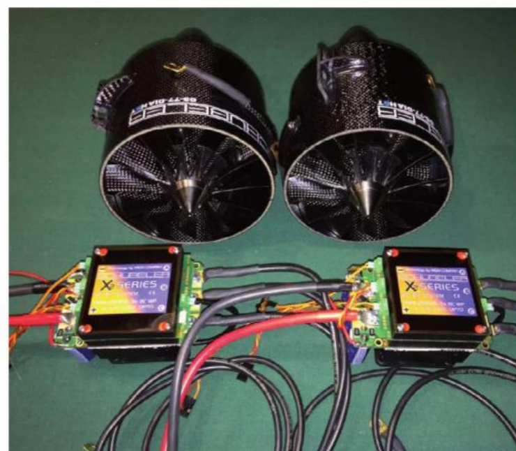
Die Antriebe: 2x Impeller DS-77-DIA HST mit DSM6745-700-Motoren und 2x Regler TMM25063-3 X2-Series von Schubeler.
