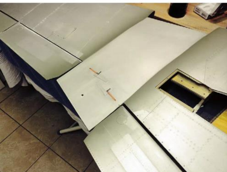
Die 2-mm-Edelstahl-Scharnierachsen für die Landeklappen werden im Gondelbereich auf der Flächenunterseite eingeführt.
