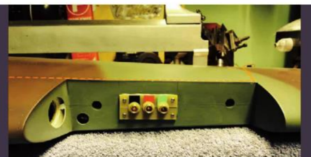
◀ Die 120-mm-Impeller passen perfekt in die Gondeln der Me 262 – die Luftführung wurde aus GFK/Aramid selbst erstellt. ▶ Die farbige Kennzeichnung der Steckverbindungen zum Impeller sorgt für die richtige Polung.
