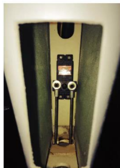
Das Seitenruderservo sitzt direkt vor dem Ruder in der Seitenleitwerksdämpfungsfäche – eine kurze Push-Pull-Anlenkung mit 3-mm-Gewindestangen sorgt für die Kraftübertragung.
