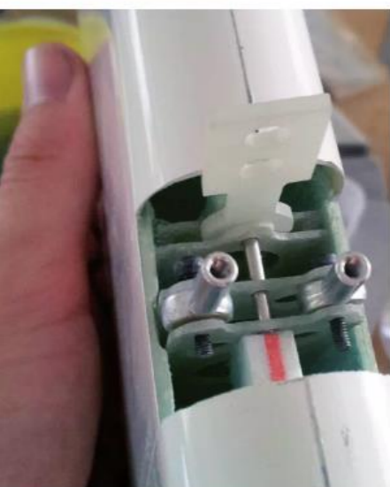
Zur Nutzung der vorbildgetreuen Anlenkungspunkte am Seitenruder liegen dem Bausatz GFK-Teile bei, die auf der Scharnierachse zentriert werden und weit ins Ruder hineinreichend verklebt werden.
