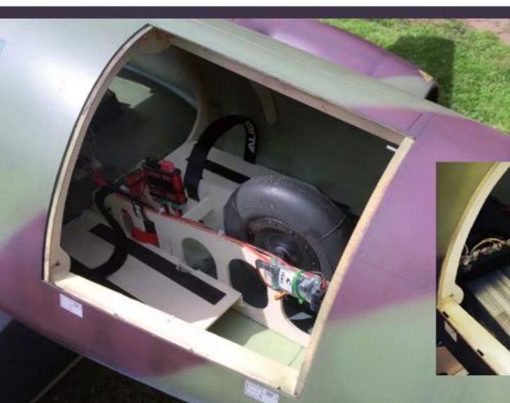
Die Akkuaufgaben wurden rechts und links neben den Längsspannten des Fahrwerksausschnittes gesetzt und sind über den Wartungsdeckel sehr gut erreichbar.
