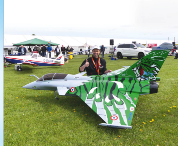
Im Slot der Luxemburger Firma JMB-Jets/KingTech-Turbinen konnte Jonathan Bossion mit der 1.5-Rafale begeistern. Der Jet ist mit einer Schubvektorsteuerung ausgerüstet, die eine atemberaubende Bodenakrobatik erlaubt. Die Spannweite beträgt 2.100 mm und die Länge 2.900 mm. Verwendet wird eine Turbine KingTech 310G
