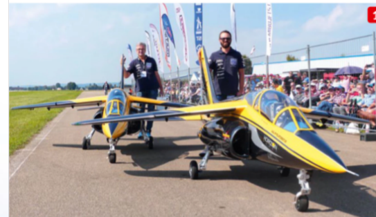
Robert und Sebastian Fuchs kurz vor dem Start ihrer gigantischen Alpha Jets auf der JetPower 2018 in Donauwörth. Die 110 Kilogramm schweren Modelle haben eine Spannweite von 3.530 Millimeter, eine Länge von 4.650 Millimeter und werden von zwei Turbinen JetCat P-400 befeuert (1). Spitze im Modellflug: das Red Bull Aerobatic Team (von links) mit Tim Stadler, Robert Fuchs und Sebastian Fuchs (2)
