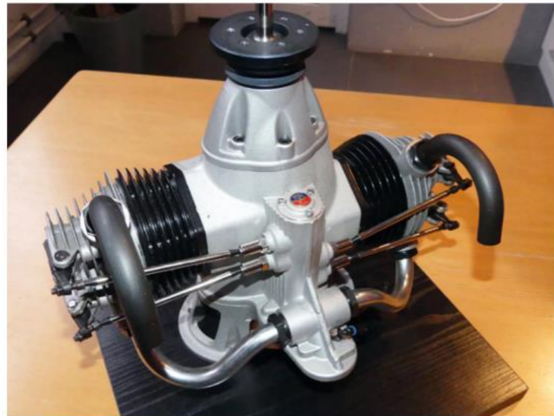
Neben dem seit Jahren erhältlichen Zweizylinder-Viertakt-Boxermotor Moki VT 100 B bietet Airworld seit letztem Jahr einen Boxer mit 160 cm 3 Hubraum an, den Moki VT 160 B. Nachdem die erste, kleine Serie verkauft wurde, ist der große Zweizylinder ab sofort wieder lieferbar. Beide Boxer-Typen sind mit Heckvergaser und einer prozessorgesteuerten Zündung mit integrierter Zündzeitpunktverstellung ausgestattet
