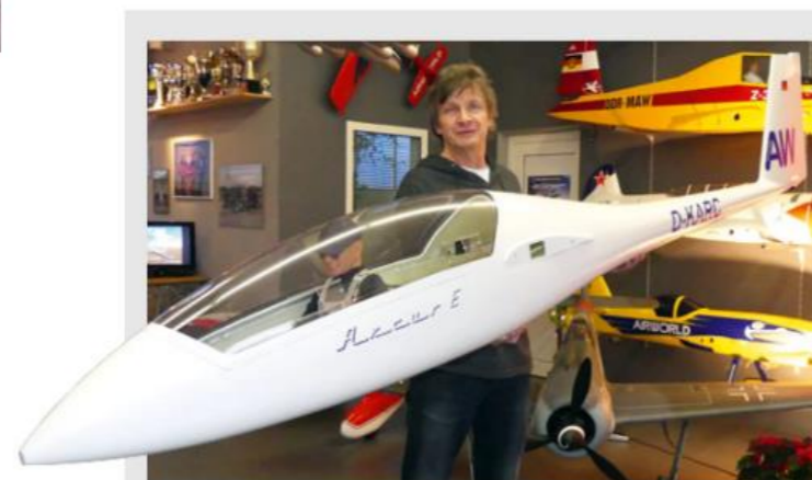
Solche Aufnahmen sind bei Airworld nur am Freitag möglich, wenn im Ausstellungsraum noch Platz ist. Airworld-Inhaber Hans-Dieter Reiser präsentiert hier den Rumpf des neuen Arcus im Maßstab 1:2,7. Das Voll-GFK-Modell mit der bekannt prägnanten Flügelgeometrie hat eine Spannweite von 7.400 mm und soll flugfertig unter der 25-kg-Grenze bleiben
