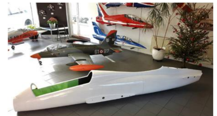
Im Vergleich zu der bekannten, im Hintergrund stehenden Airworld MB-339 mit 2.800 mm Spannweite und 3.000 mm Länge, verdeutlicht allein die Rumpflänge der im Maßstab 1:2,4 gefertigten Giant MB-339, was da entsteht. Der feinst detaillierte Jet hat eine Spannweite von 4.200 mm und wird ein Abfluggewicht von etwa 70 kg auf die Waage bringen. Der Erstflug soll noch 2019 erfolgen
