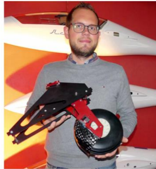
Bernhard Kager, der in Österreich einen Bauservice für Großmodelle betreibt, zeigt uns hier das gigantische Einziehfahrwerk für den neuen, zulassungspflichtigen Airworld-Swift im Maßstab 1:1,4. Das Fahrwerk weicht mit einem Maßstab von 1:1,5 nur unwesentlich ab
