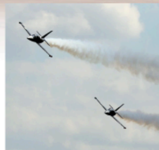
Das Swiss Formation Jet-Team flog diesmal mit zwei statt drei L-39 Albatros von Tomahawk. Trotzdem immer wieder eine sehenswerte Vorführung. Die Jets im XXXL-Format haben eine Spannweite von 3,5 m, eine Länge von 4,5 m und wiegen zirka 77 kg. Für den nötigen Vortrieb sorgt je eine JetCat-Turbine P-550 mit etwa 55 kg Schub
