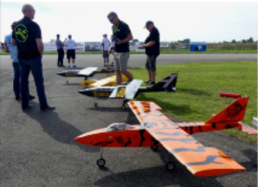
Der Laser- und Fräservice Trost war gleich mit vier Holz-Bausatzmodellen am Start. Die einfach gestalteten Trainer haben Spannweiten von 1,6 m bis 2 m, wiegen zwischen 7 und 12 kg und können mit 50- beziehungsweise 100- bis 140-N-Turbinen betrieben werden
