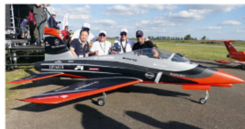
Das Team Jet Israel mit dem Piloten Lior Zahavi flog für den chinesischen Hersteller TopRC Model die 2,79 m spannende und 3,25 m lange Voyager. Als Antrieb eignen sich Turbinen von 18 bis 26 N. Das große Modell lässt sich für den Transport mehrfach zerlegen
