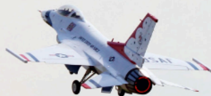
Im Flugslot der Firma Final-Modellbau führten Patrick Starck und Marco Zaugg ihre beiden großen F-16 vor. Die zulassungspflichtigen Jets (Maßstab 1:5, Spannweite 2,04 m und Gewicht 29 kg) vom chinesischen Hersteller JetLegend Europe werden jeweils von einer Frank-Turbine FT250 befeuert. Die F-16 gibt es auch im Maßstab 1:6, die dann weit unter 20 kg flugbereit ist
