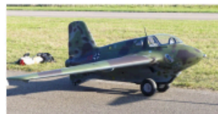
Airworld war mit einer ganzen Reihe von Modellen am Start. Neu ist die Messerschmitt Me-163 im 1:3-Maßstab. Die Spannweite beträgt 3,2 m und das Abfluggewicht liegt unter 25 kg. Motorisiert ist der Jet mit einer JetCat P220. Pilot war Thomas Gleissner
