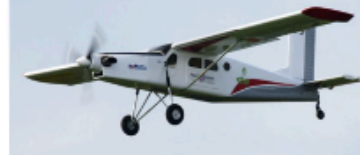
Bei der Vorführung der Pilatus PC-6 Turbo Porter von TS-Modelltechnik war Firmeninhaber Thomas Schulz selbst am Steuer. Das Voll-GFK-Modell hat eine Spannweite von 3,74 m und wiegt 21,16 kg. Die Propeller-Turbine JetCat SPT-5 V3 treibt einen 25 x 10-Zoll-SEP-Holzprop an
