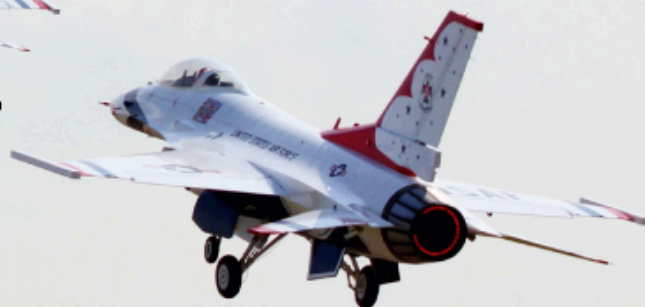
Im Flugslot der Firma Final-Modellbau führten Patrick Starck und Marco Zaugg ihre beiden großen F-16 vor. Die zulassungspflichtigen Jets (Maßstab 1:5, Spannweite 2,04 m und Gewicht 29 kg) vom chinesischen Hersteller JetLegend Europe werden jeweils von einer Frank-Turbine FT250 befeuert. Die F-16 gibt es auch im Maßstab 1:6, die dann weit unter 20 kg flugbereit ist
