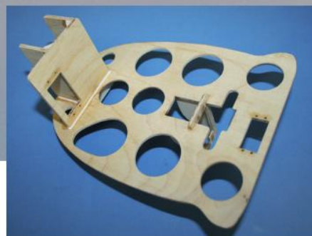
Der Spant selbst übernimmt gleich mehrere Aufgaben (siehe Text). Seitlich ist die Halterung für die Höhenruder-Bowdenzüge zu sehen. Letztere mussten später verlängert werden, um das Höhenruderservo weiter vorne platzieren zu können.
