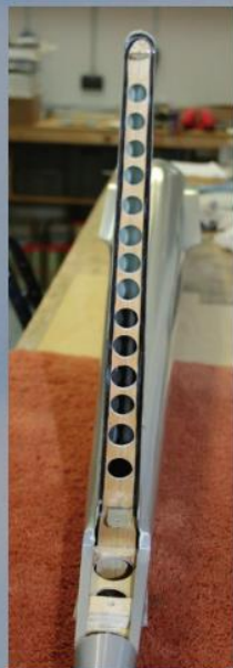
Der Abschlussspant mit den beiden GFK-Zungen zur Lagerung des Seitenruders wird durch einlaminierete CFK-Rovings verstärkt. Um den Ballast vorne zu verringern, mussten Erleichterungsbohrungen geschaffen werden.
