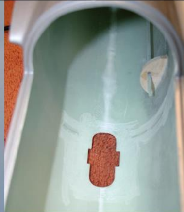
Die Öffnung für das Rad muss noch erstellt werden. Danach wird der Rumpf im Klebebereich des Hauptspants gut angeschliffen.
