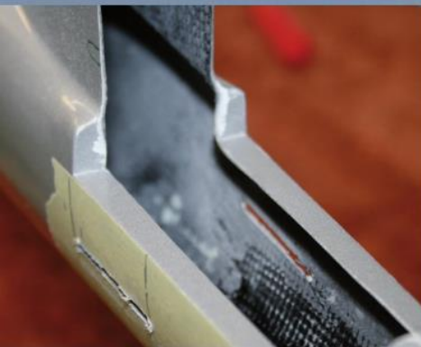
Der Rumpf hat im Bereich der Seitenruderdämpfung eine massive CFK-Verstärkung. Dies verleiht zusammen mit dem noch einzuklebenden Abschlussspant ausreichend Stabilität. Auch zu sehen: die eingefrästen Öffnungen für den beidseitigen Austritt der Höhenruderenlenkung.
