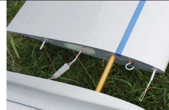
Hier sieht man alle Anschlüsse an der Flächenwurzel. Der hintere Torsionsstift ist bereits herstellereitig verklebt, der Haken zur Aufnahme der Spanngummis ist in Eigenregie eingebaut.
