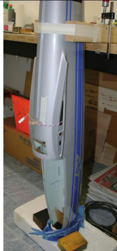
▲ Der notwendige Ballast in Form von 3-mm-Kugeln wird in der Rumpfspitze mittels Epoxidharz vergossen. Aufgrund der Wärmeentwicklung beim Aushärten des Harzes kühle ich den vorderen Bereich mit Gelpads. Dies verhindert ein eventuelles Abzeichnen der Gewebestruktur durch übermäßige Erwärmung.
