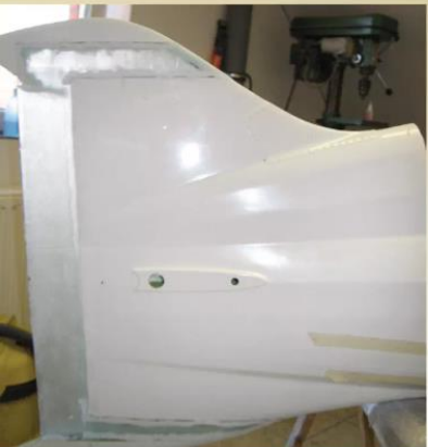
Zur Verbesserung der Flugeigenschaften wurde die Seitenleitwerksfläche vergrößert.
