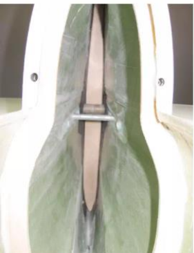
Zusätzlich wurde auch das Höhenleitwerk nach hinten versetzt.
