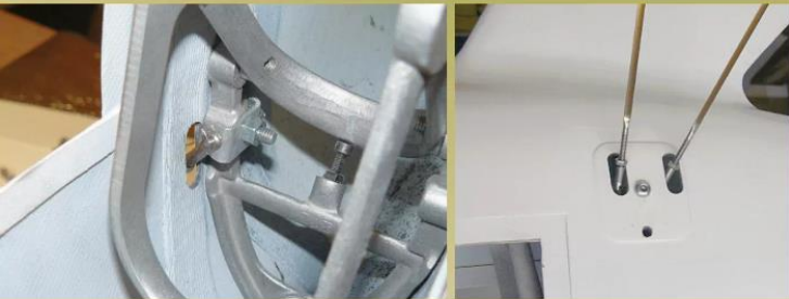
Die Spannseile wurden direkt am Fahrwerksbügel befestigt.
