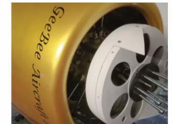
Der Spinnerübergang: Die Kühlluft wird direkt zu den Zylindern geführt.
