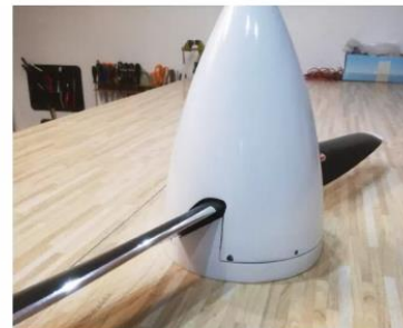
◀ Die Spinnergrundplatte wurde nach hinten verlängert. Zwischendurch hieß es, immer das Gewicht im Auge zu behalten. Allein Spinner und Luftschraube bringen 720 g auf die Waage.
