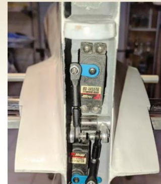
Die beiden Höhenruder-Servos sitzen im Seitenleitwerksholm und bedienen die Höhenruder redundant. Die Vierkantsteckung zur Anlenkung der Höhenruderblätter ist mittig getrennt.
