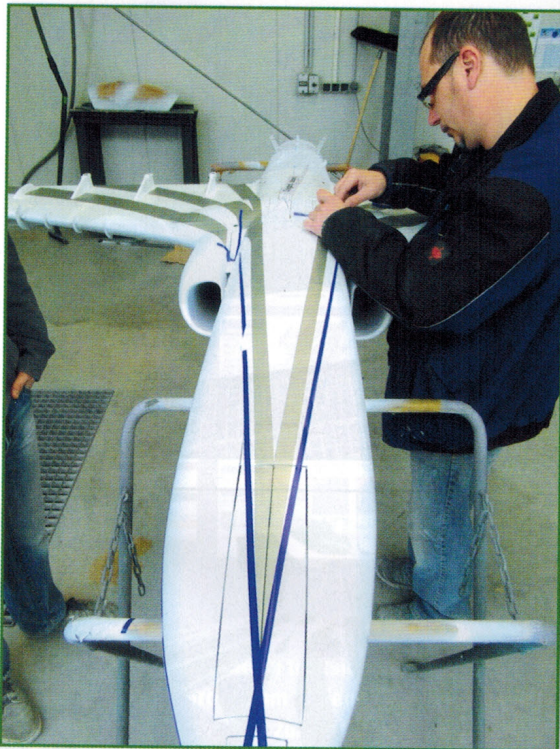
Nachdem der Grundlack aufgetragen war, konnte mit den umfangreichen Abklebearbeiten begonnen werden.
