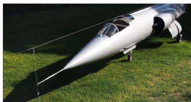
Mit Hilfe einer Schnur und einem Lot kann die Nase zur Verklebung sauber ausgerichtet werden
