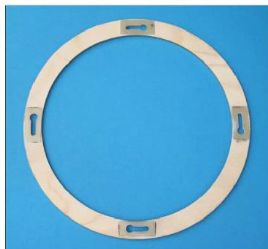
Der vordere Rundspant mit den Ausfräsungen für den Bajonett-Verschluss der Nase
