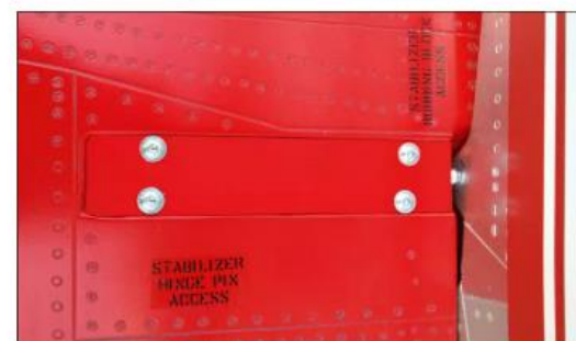
Das Pendelruder ist auf einem Stahldraht gelagert und wird von unten verschraubt
