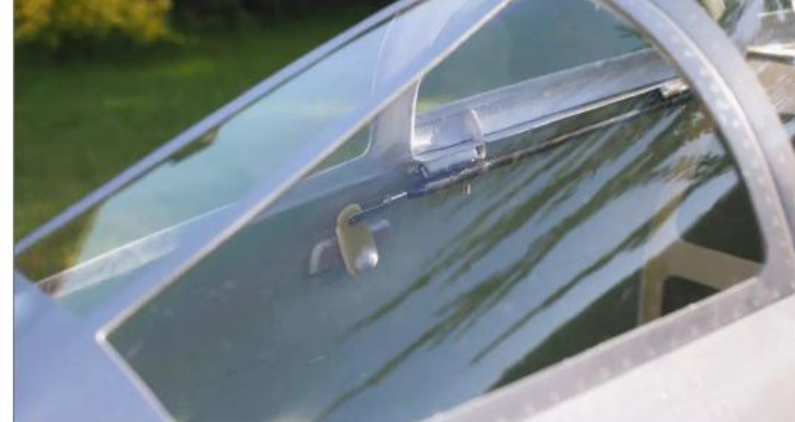
Als Haubensverschluss wurde eine Eigenbau-Lösung eingebaut
