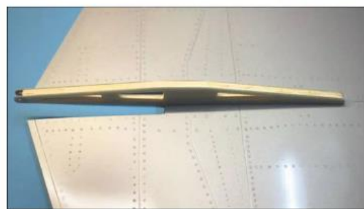
Die Wippe dient zur Anlenkung des Höhenruders
