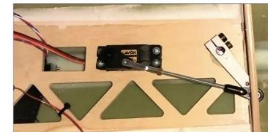
Die Landeklappen werden über äußere Hebel bewegt, die über eine Welle mit Innenhebeln verbunden sind
