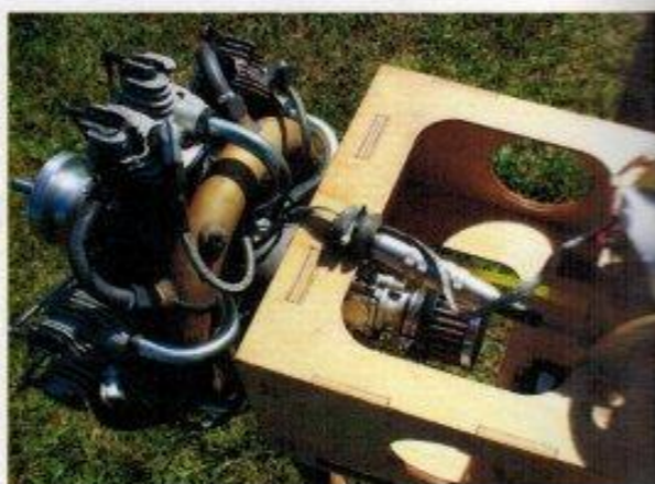
Perfekt passen Turbulator und Luftfilter in den langen Motorträger – es fallen keine zusätzlichen Fräsarbeiten an. Auch der wirkungsvolle Moki-Ringschalldämpfer ist deutlich zu sehen
