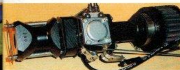
Damit der Vergaser des Sternmotors optimal funktioniert und sich die Gasannahme über den gesamten Drehzahlbereich verbessert, haben wir den Turbulator von Detlef Kunkel samt Luftfilter zwischen Vergaser und Motorrückwand geschraubt
