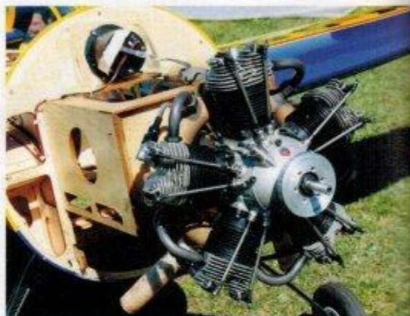
Der Moki Fünfzylinder-Sternmotor passt mit seinen 250 Kubikzentimeter Hubraum samt Ringschalldämpfer spielend auf den Motorspant und unter die runde Cowling. Dahinter ist die Zündanlage auf die Firewall geschraubt
