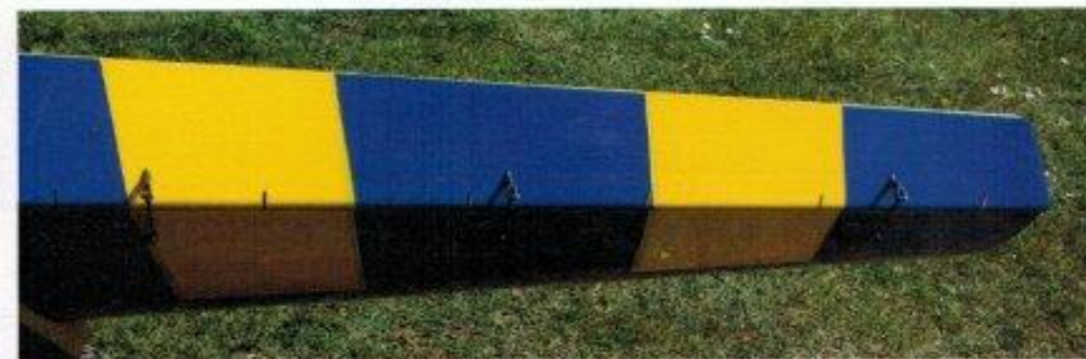
Jedes Querruder wird von drei Spektrum-Servos S6030 mit Gabriel CFK-Gabelruderhebel über spielfreie Kugelgelenke angesteuert
